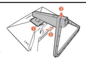
II. モニタベースの底面にあるネジのつまみを掴みネジを外し、モニタベースを外します。
