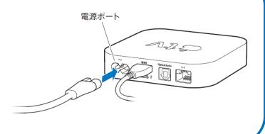
④反対側を 電源コンセントに差し込みます。
