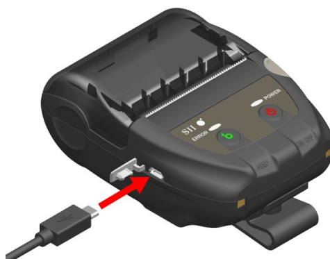
図 8-1 プリンタとUSBケーブルの接続
