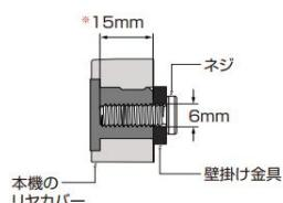
※付属のネジの長さが足りず、壁掛け金具の取り付けができない場合はワッシャーを外して取り付けてください。
