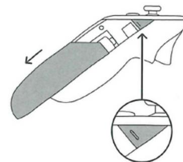
取り出しボタンを押し、バッテリーカバーを開いたら、滑らせるようにして外してください。
