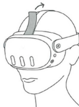
ストラップを頭にかぶり、両手を使って2本のスライダーを耳の方にスライドさせて固定します。
