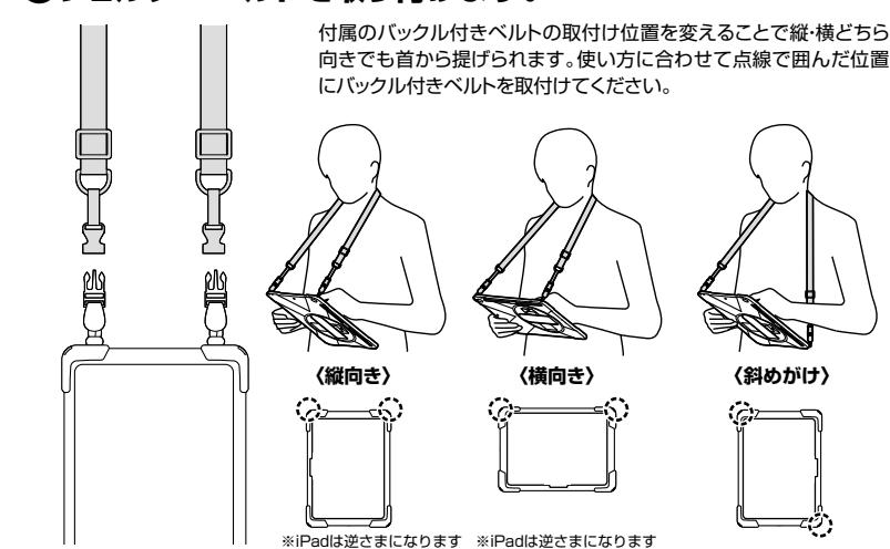
付属のバックル付きベルトの取付け位置を変えることで縦・横どちら向きでも首から掛けられます。使い方に合わせて点線で囲んだ位置にバックル付きベルトを取付けてください。
